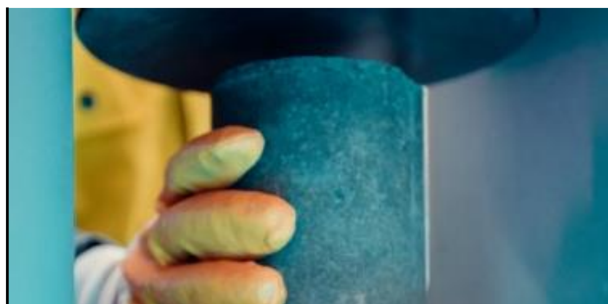
Тестирование укрепленного Грунта / АГБС
