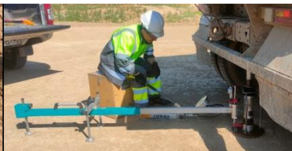
Штамповые испытания укрепленных грунтов
