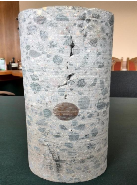
Дефект в бетоне при погружении дюбелей
