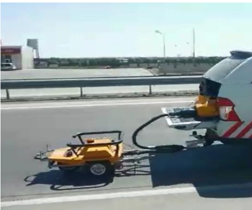
Общий вид передвижной лаборатории с установкой GripTester
