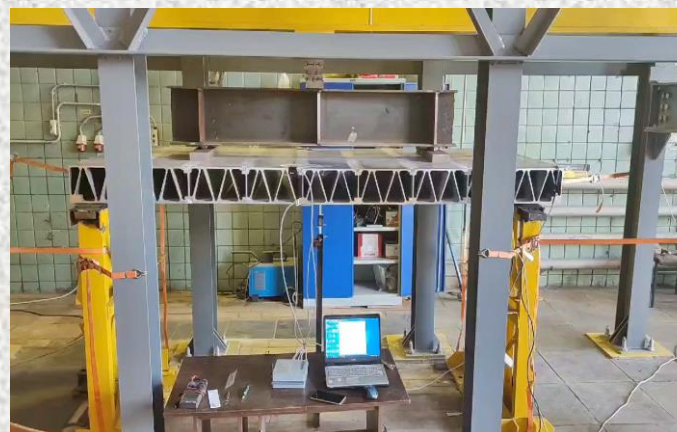
Испытание на усталостную долговечность
