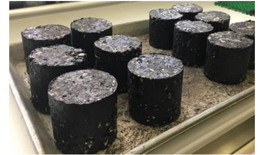
асфальтобетон, модифицированный резиновой крошкой
