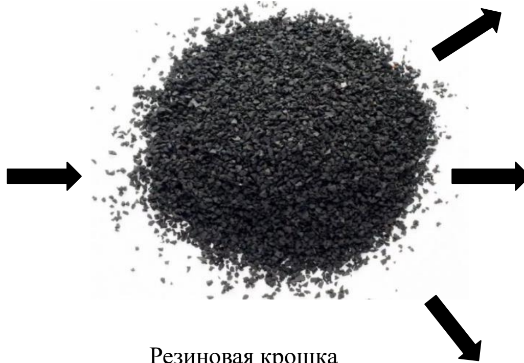
асфальтобетон, модифицированный резиновой крошкой
