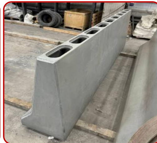
Несъемная опалубка из СПФБ (в стадии запуска)
