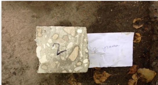
Образец-кern из покрытия экспериментального участка автомобильной дороги
