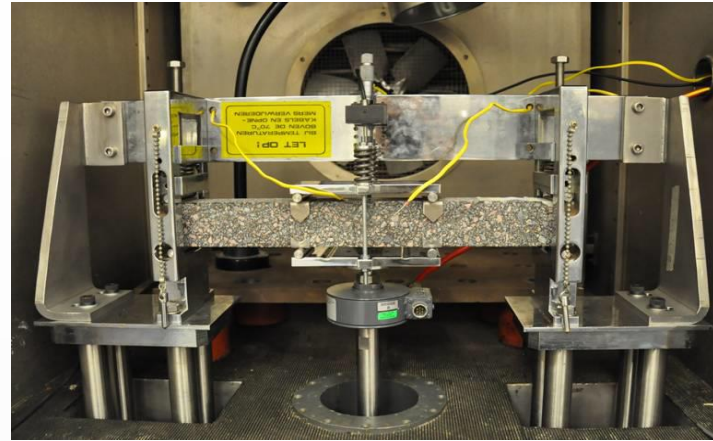
Установка для усталостных испытаний балочного асфальтобетонного образца на 4-х точечный изгиб
