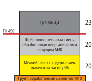
Рис. 2.9. Конструкции дорожных одежд в Свердловской области
