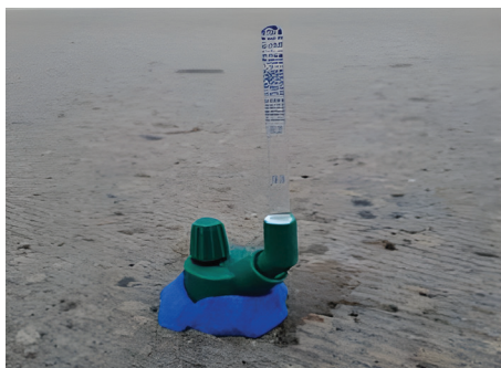
Рис. 11. Измерение водонепроницаемости цементобетонного дорожного покрытия с помощью «Трубки САЗИ»
