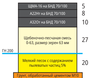
Рис. 2.7. Конструкции дорожных одежд в Московской области
