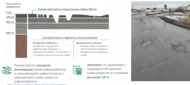
Рис. 3. Выбор технологии ремонта автодороги при разрушениях 100-300 мм
