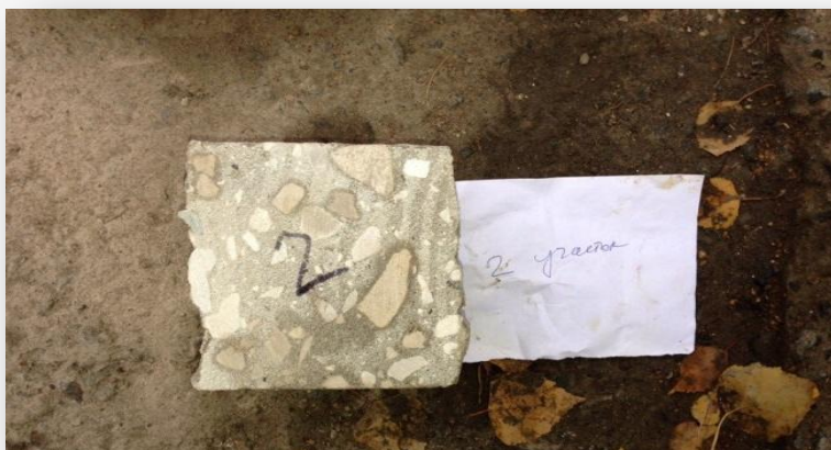
Образец-кern из покрытия экспериментального участка автомобильной дороги
