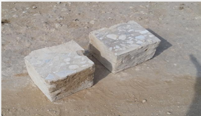
Образец-кern из покрытия экспериментального участка автомобильной дороги
