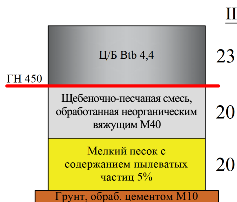
Рис. 2.7. Конструкции дорожных одежд в Московской области
