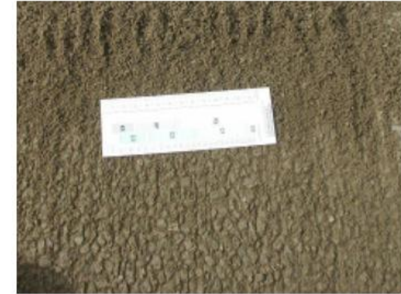
Определение момента для обнажения заполнителя
