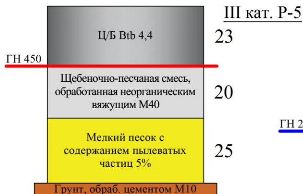
Рис. 2.3. Конструкции дорожных одежд в Мурманской области
