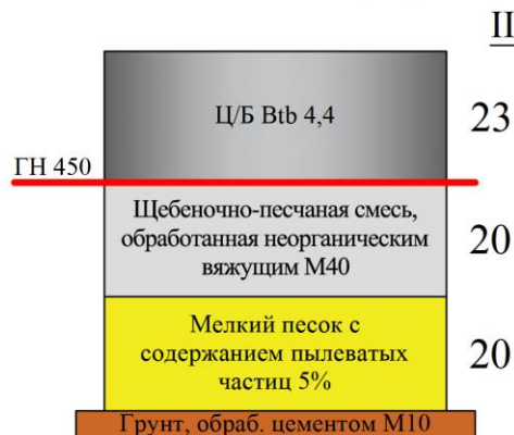
Рис. 2.5. Конструкции дорожных одежд в Ленинградской области
