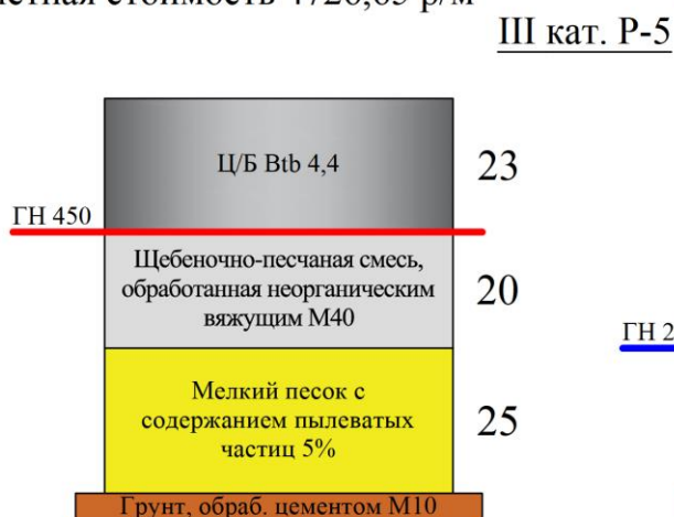
Рис. 2.17. Конструкции дорожных одежд в Оренбургской области
