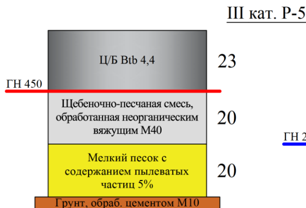
Рис. 2.15. Конструкции дорожных одежд в Самарской области
