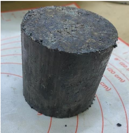
Лабораторный образец из холодной органоминеральной смеси с использованием РАП и эмульсии FF
