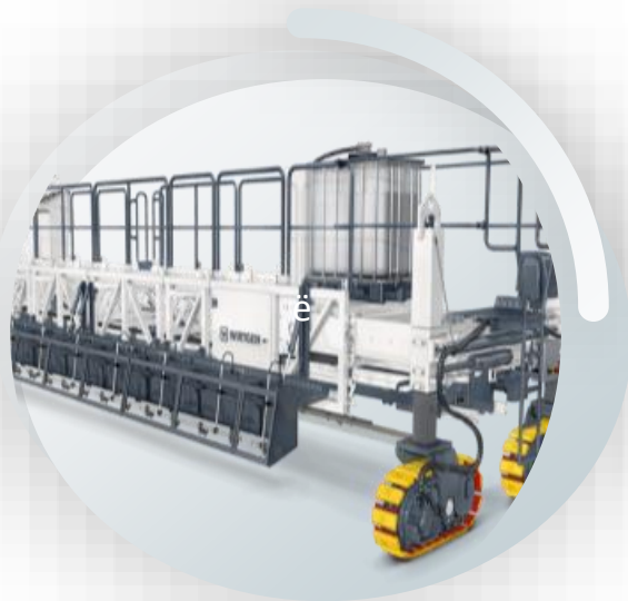
Текстурировщики Gunter & Zimmermann TC 1500 в количестве трех единиц (рабочая ширина от 3 до 16 метров)
