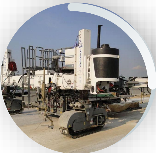
Бетоноукладочный комплект Gunter & Zimmerman S600 (ширина укладки от 3 до 8 м., толщина до 0,45 м.)
