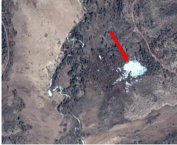
Наледеобразование при перемерзании грунтового стока осенью
