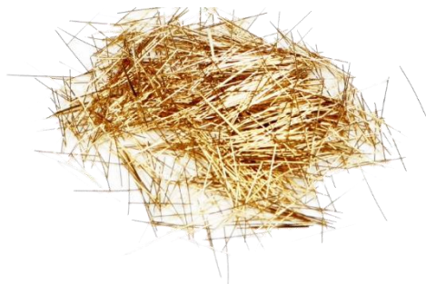
Стальная фибра L_f = 14 \text{ мм}
