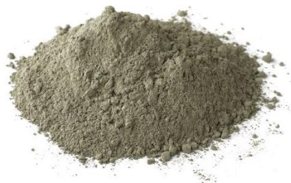
Сухая смесь D_{\max} = 0,67 \text{ мм}
