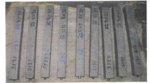
Рисунок 2. Внешний вид образцов из бетонной смеси СВНДАб Ductal® G2TXFM32SSTT Тиксотронная, помещенных в дистиллированную воду, после окончания 12 месячных испытаний
