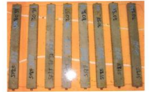
Рисунок 1. Внешний вид образцов СВНДАб Ductal® G2TXFM32SSTT Тиксотронная, помещенных в 5% растворе сульфата натрия после окончания 12 месячных испытаний
