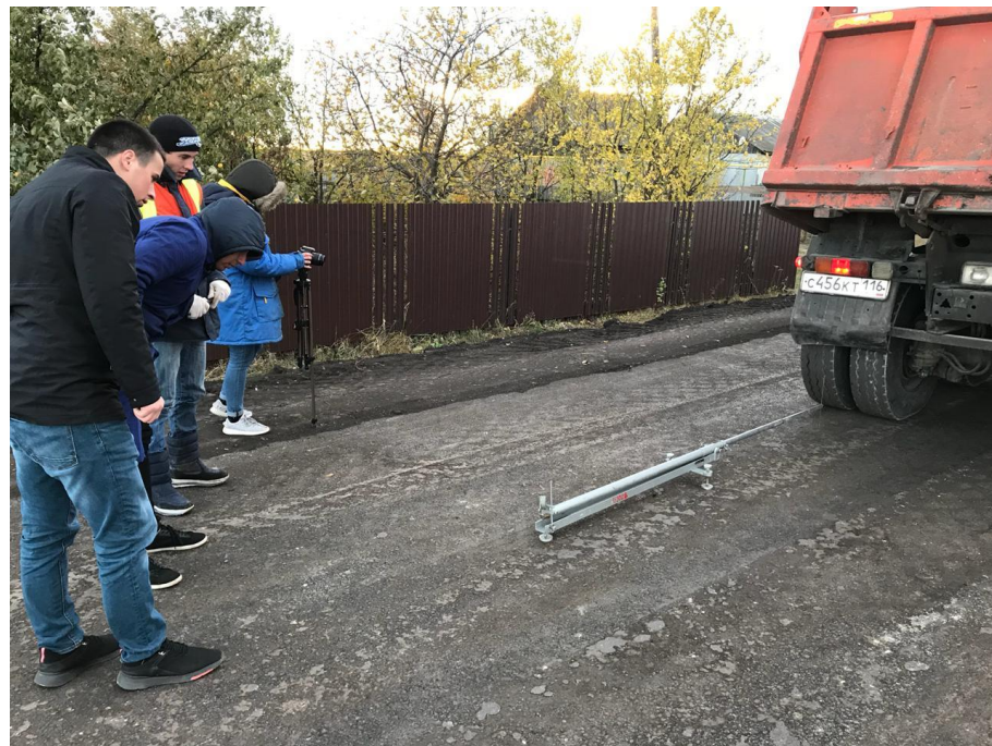
Определение прогибов (модуля упругости) на экспериментальных участках
