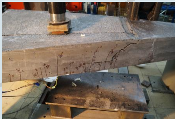
Распределение трещин в ребре образца
