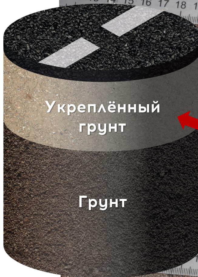
Технология укрепления грунта модификатором «Акропол ГСМ»
